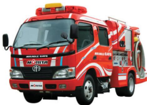
込むことで発泡させる技術です。この装置によって水の表面積は極大化し、少量の水での消火活動が可能となります。今回のMiracle CAFS Carは、600ℓの水と2ℓの消火薬剤で、実に約10tの水と同等の消火性能を備えています。
