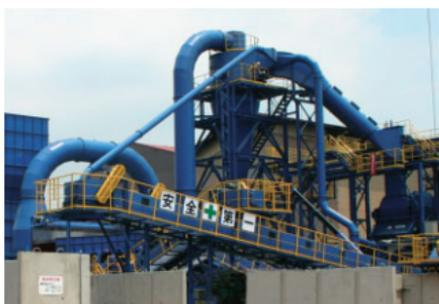
この製品は従来品の処理能力をはるかに上回る（毎時60～100トン）だけでなく、自動化システムも導入。市中一般屑を破碎するシュレッダーでは国内最大級のものです。市中一般屑を破碎・選別し、スクラップへと加工するシュレッダーは循環型社会を構築する大切な機械です。モリタは環境事業にもたゆまぬ技術革新を続けてまいります。
