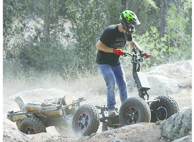
EZ-Raider はフロントカートとリヤカートで構成され、フロントカート(4輪)およびリヤカート(2輪)すべてのホイールには高トルク電動モータを搭載しています。連結させると最大6輪駆動となり、より高い走破性を発揮します。大容量リチウムイオン電池と回生モータにより約45km~80kmの航続距離を確保しており、積載重量はフロントカート200kg<sup>※</sup>+リヤカート250kgで、最大450kg<sup>※</sup>の物資搬送が可能です。
