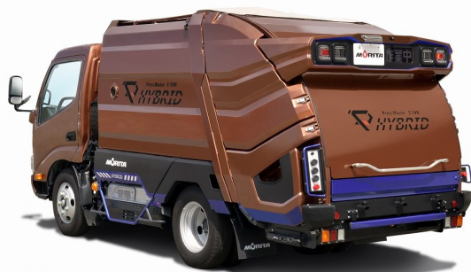
プレス式電動塵芥収集車「プレスマスター イー・セブン」
