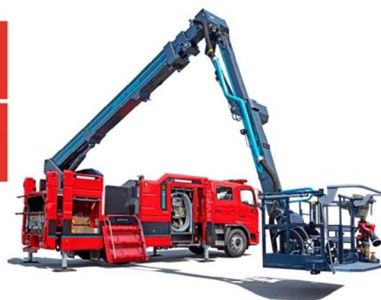
MVF21 は、当社の連結子会社であるフィンランドの BRONTO SKYLIFT OY AB とモリタがお互いの技術を活かして開発した 21m のブームと最大 4,000N 対応のバスケットを搭載。高所での活動だけでなく、車いすに乗ったままのバスケット搭乗、救助が可能になりました。少量の水で消火活動ができる CAFS 装置と 900ℓ の水タンクを搭載しながらも十分な収納スペースも確保。多様化する火災現場での消火、救助活動に応える多目的な消防ポンプ自動車です。
