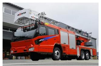
今回、発表の水路付先端屈折式はしご車「SUPER GYRO LADDER MLL シリーズ」は、はしごの軽量化に伴い、はしごの伸縮・起伏スピード、作業範囲の拡大を大幅に向上いたしました。また、1 秒でも速く 救助活動と消火活動を円滑に行えるよう最新式の制御装置を兼ね備え、使いやすさを重視したはしご車です。
