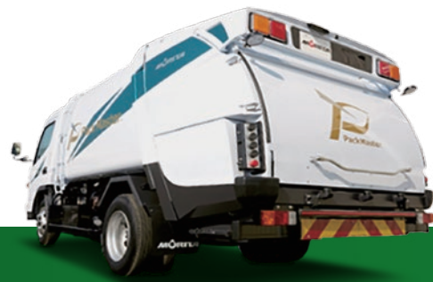
塵芥車 回転式塵芥車 家庭ごみ収集に広く使われる回転式タイプ。回転ドラムでゴミをかき込み、効率的に積み込む方式
