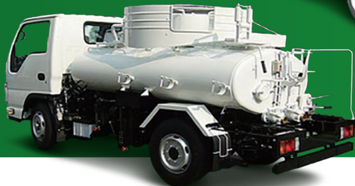
衛生車 バキュームカー し尿収集や浄化槽清掃に用いられ、公衆衛生を支える、地域の衛生環境維持に欠かせない存在。また、給水車としても活躍
