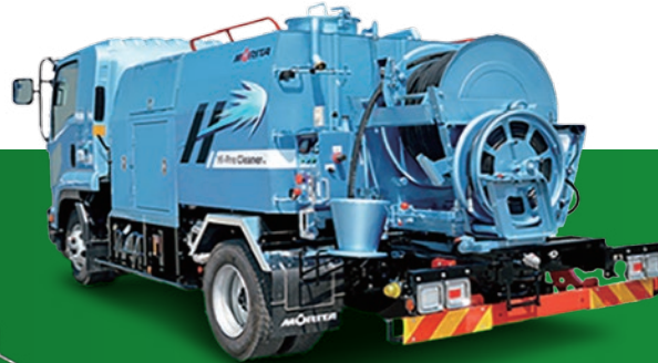
特装車 高圧洗浄車 高圧水により下水管や生活排水管内を洗浄する。側溝清掃など、さまざまな現場で活躍
