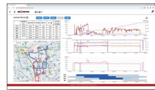
走行経路 / ポンプ稼働ログ画面
