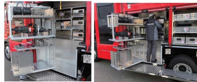
後輪前方のエプロンボックスは、フロアレス構造に対応。
