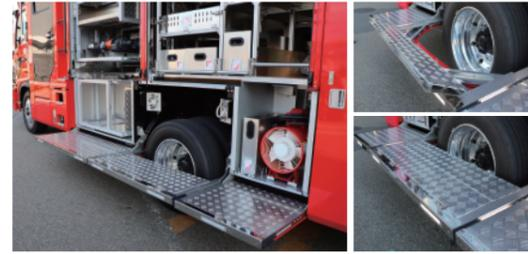
高さ、張出幅共にフルフラット構造で、かつ、隣り合うステップ間や、リアフェンダー部の隙間を最小限に設定！安全なステップ間の移動が可能。
