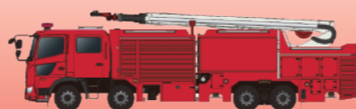
消火薬剤タンク付き大型化学高所放水車 インテグレートワン
